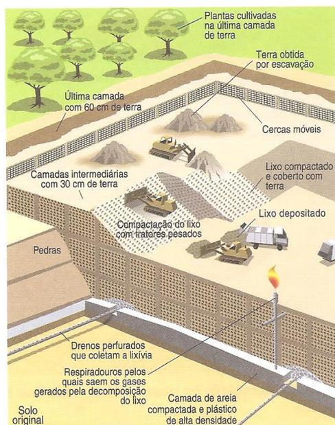
Figura 8. Aterro sanitário em uso, com as camadas de lixo e de terra sobrepostas sendo compactadas.
